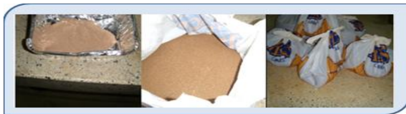
Fotografía 6. Recolección del material por tamiz.
