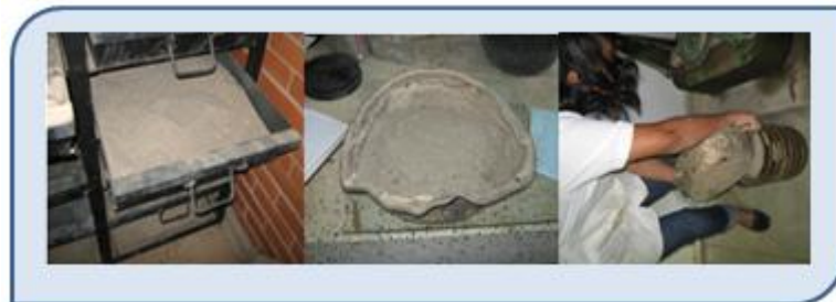
Fotografía 25. Granulometría de la arena por el método mecánico
