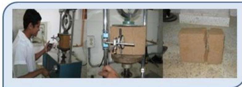
Fotografía 39. Aplicando la respectiva carga para la falla de las probetas
