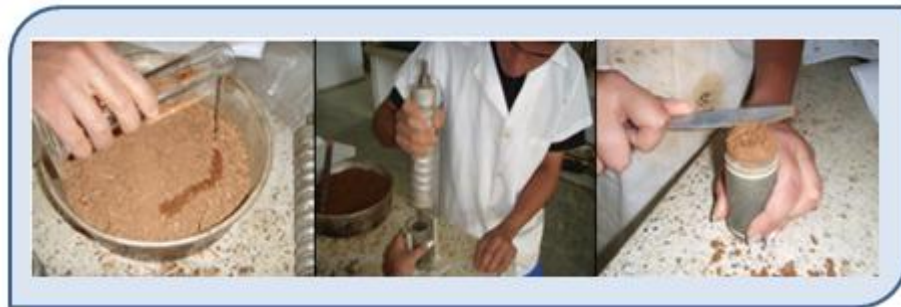
Fotografía 17. Preparación y Compactación de la probeta.
