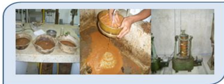
Fotografía 1. Selección del material, lavado y tamizado
