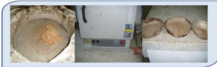
Fotografía 2. Muestra húmeda y seca.
