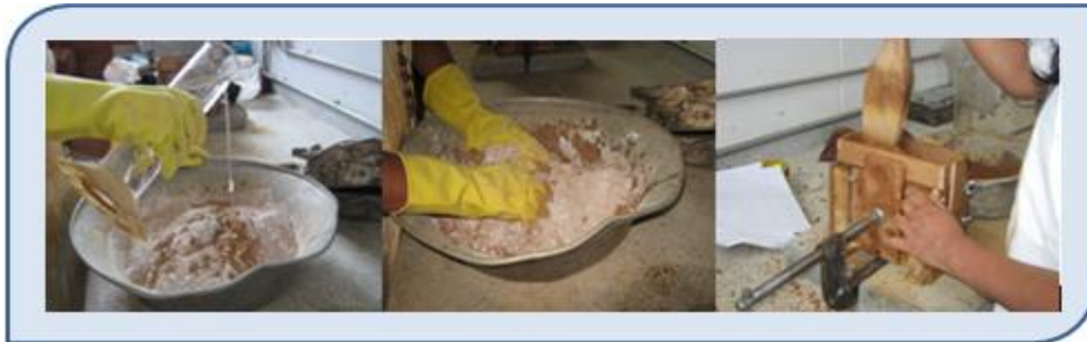
Fotografía 30. Preparación y Compactación de la muestra en molde
