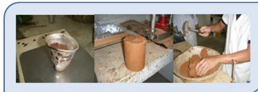
Fotografía 16. Selección de la humedad óptima
