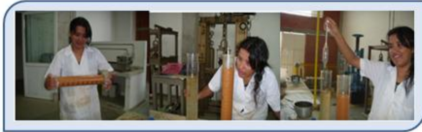
Fotografía 22. Agitación y toma de resultados con el hidrómetro.
