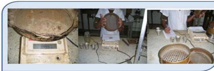
Fotografía 3. Peso de la muestra y toma de resultados.
