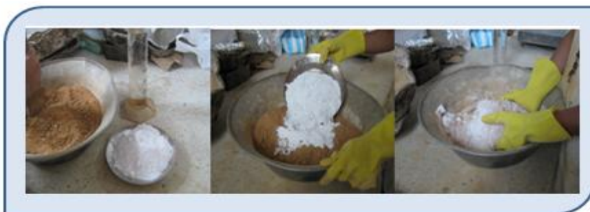
Fotografía 29. Mezclado del suelo natural con Cal
