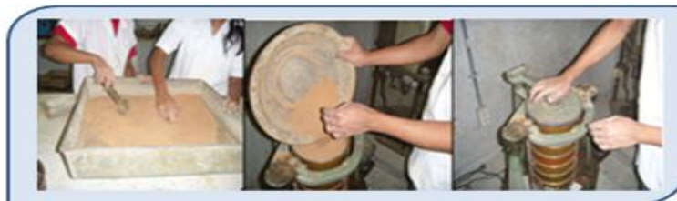
Fotografía 4. Trituración del material y tamizado.
