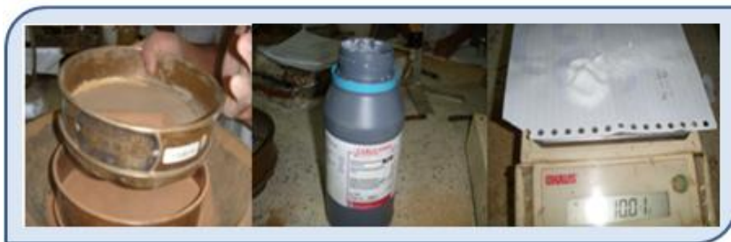
Fotografía 20. Tamizado y aplicación del hexametáfosfato de sodio a la muestra.
