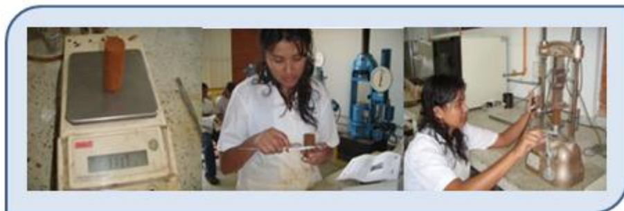
Fotografía 18. Peso, medida de dimensiones y falla a compresión.
