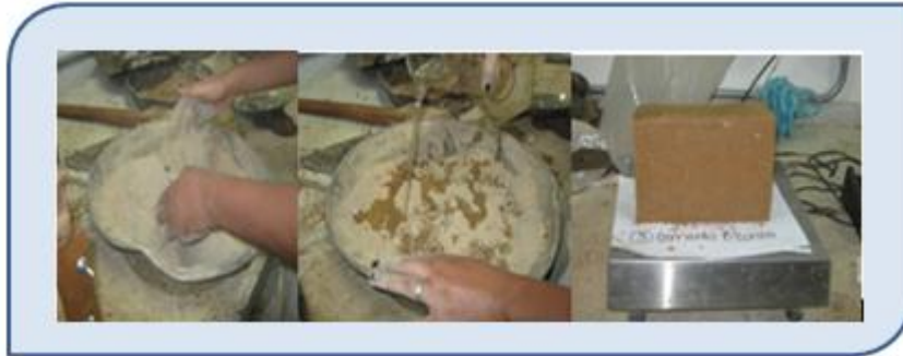
Fotografía 35. Mezclado del suelo natural con cemento
