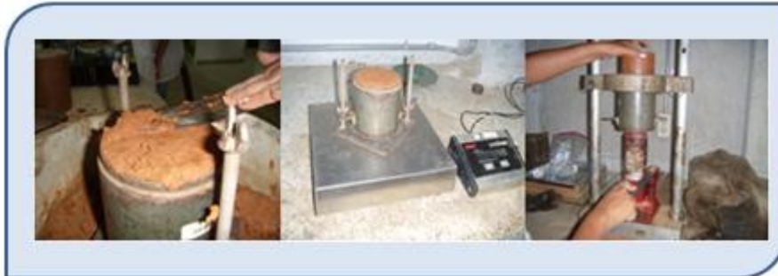
Fotografía 16. Selección de la humedad óptima
