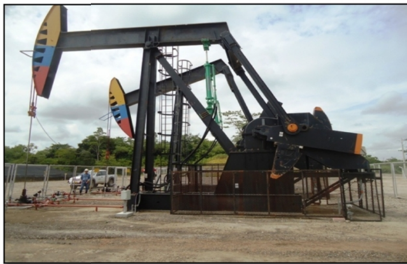
Figura 2. Unidad de Bombeo Mecánico
