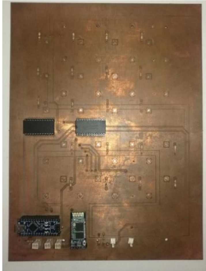
Figura 45. PCB Tablero comandos, vista superior
