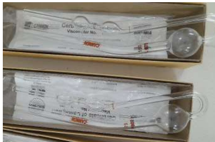
Viscosímetro de Ostwald (Capilar)
