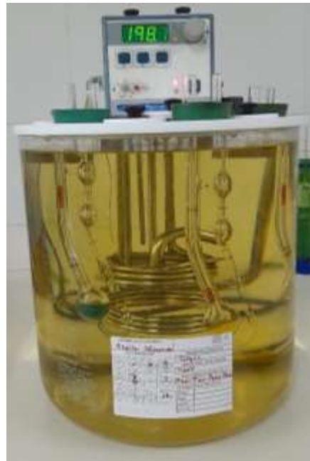
Baño de Aceite térmico para el Viscosímetro de Ostwald
