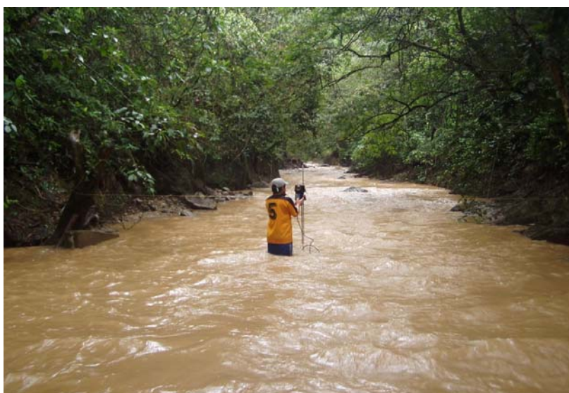
FIGURA 32. Sección Transversal para el aforo.
