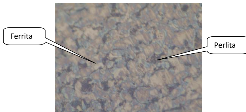
Fotografía 1. Microestructura del acero AISI-SAE 1020 atacado con Nital al 2%. Granos de Ferrita y perlita. 200x.
