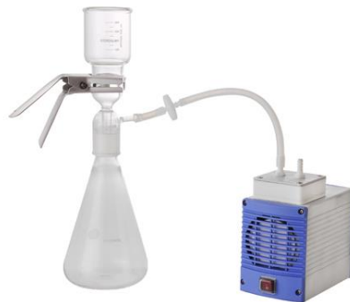
Figura 11. Bomba de vacío y equipo de filtración.
