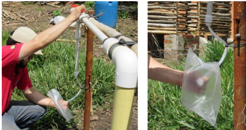
Figura 54. Toma de muestra de biogás para ser analizada
