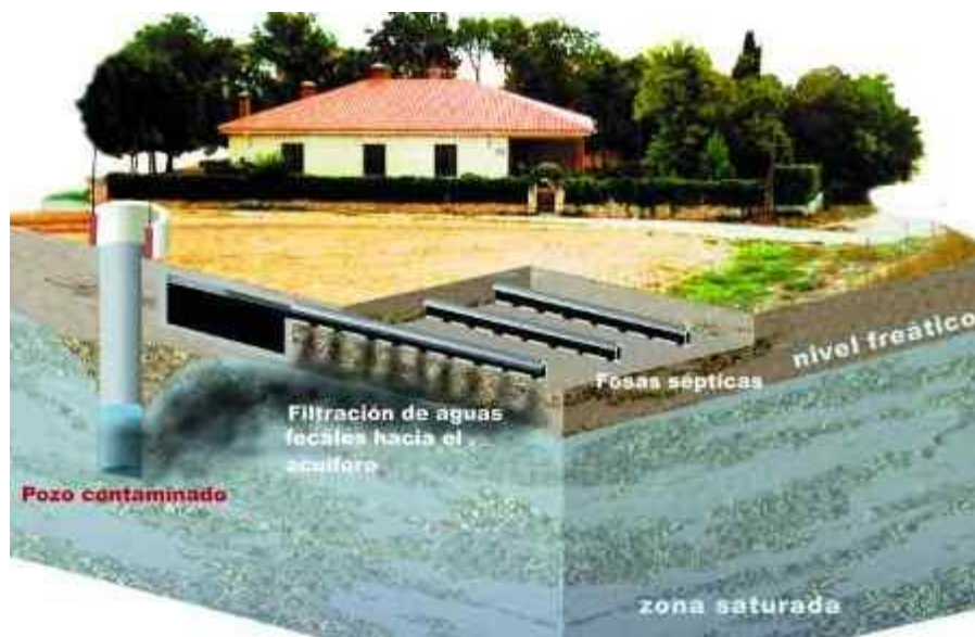
Figura 5. Contaminación de agua subterránea por filtración desde fosa séptica
