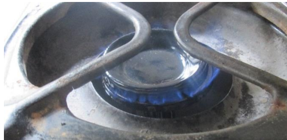
Figura 55. Llama conseguida tras el ajuste del inyector y la lumbrera
