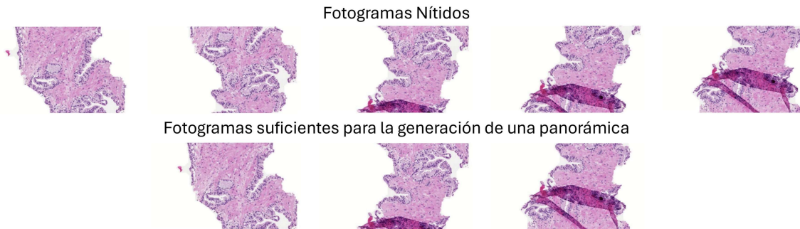
Figura 4.6: Ejemplo del descarte de fotogramas tras encontrar los mejores pares. Nótese que los fotogramas 2 y 4 de la primera fila pueden ser descartados por poseer información presente en sus fotogramas contiguos, es decir, los número 1,3 y 5.
