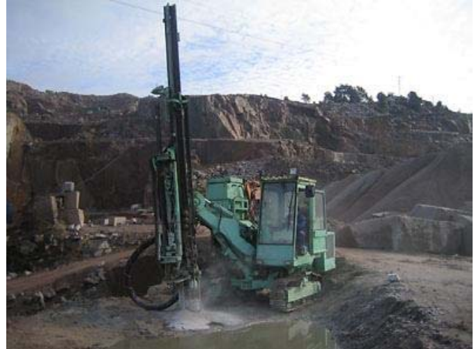
Fotografía 1. Ejemplos de perforadoras propicias para ejecución de micropilotes perforados.
