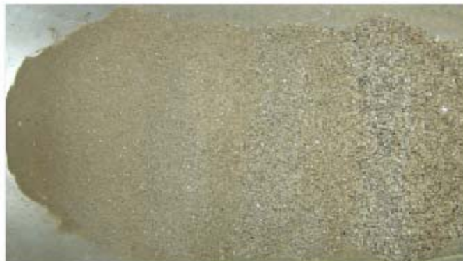
Figura 3.2 Partículas de forma redondeada entre el pasa N°10 y retenido el tamiz N°200
