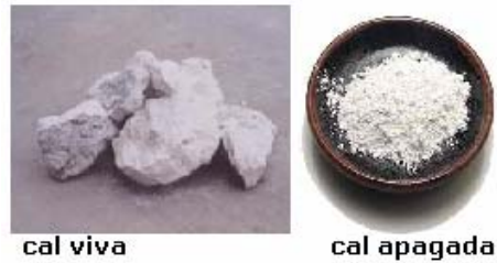
Figura 2.2 Cal viva y cal apagada
