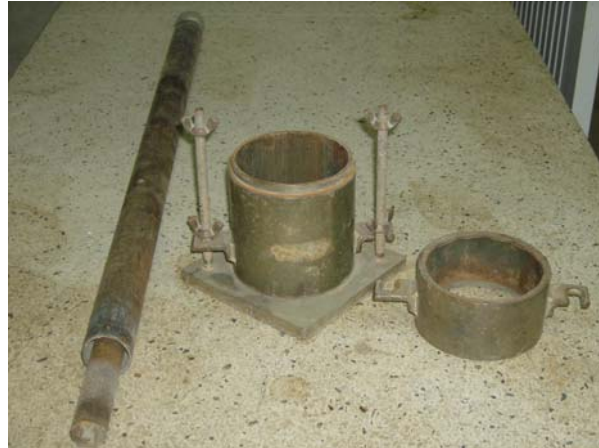
Figura 4.5 Equipo utilizado en el ensayo de proctor estándar
