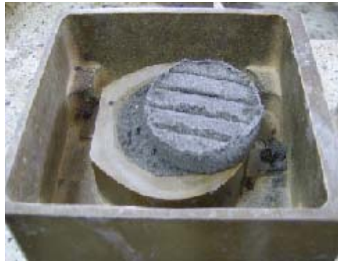
Figura 4.8 corte generado en la muestra ceniza volante- arena
