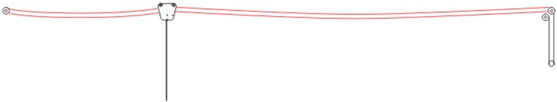
Figura 26. Sistema con presencia del fenómeno de catenaria
