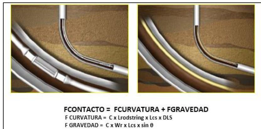
Figura 10. Cargas de contacto entre varilla y tubería.
