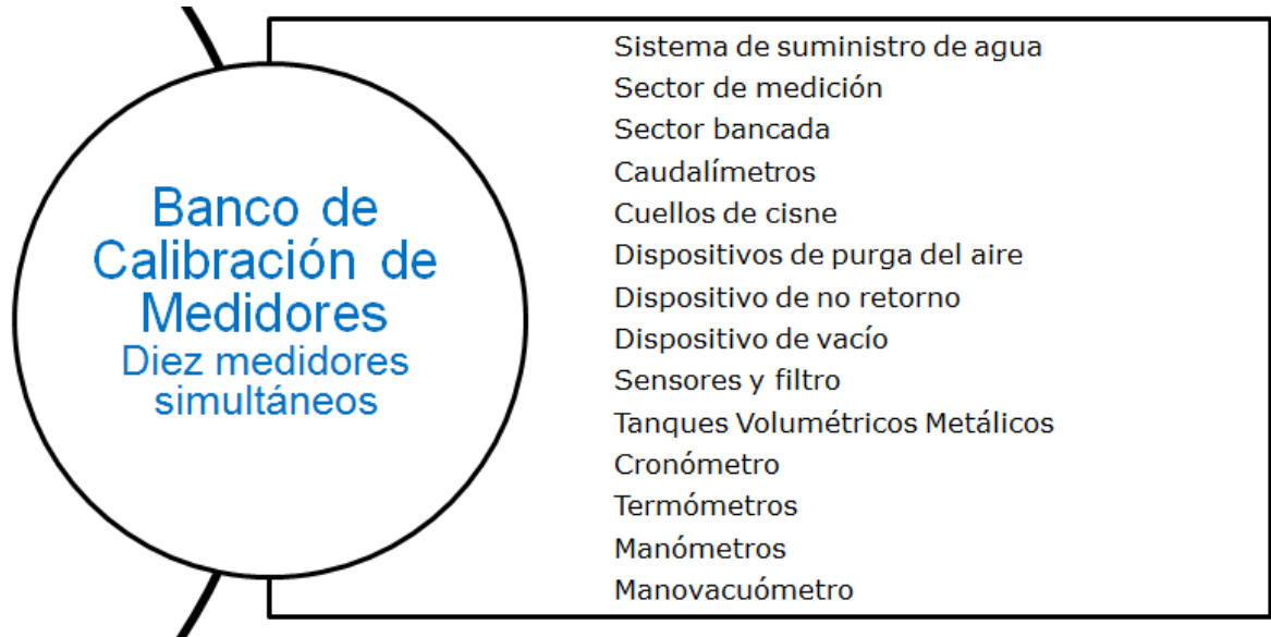
Figura 28. Descripción del Banco de Calibración de Medidores
