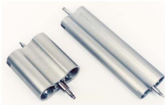
Figura 17. El perfil cuadrado del rotor IRM 3 (L) comparado a un convencional (R)
