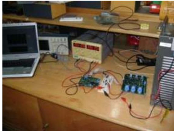
Figuras 6.16. Montaje utilizado en el laboratorio de máquinas con el que se probaron los canales de tensión de la tarjeta
