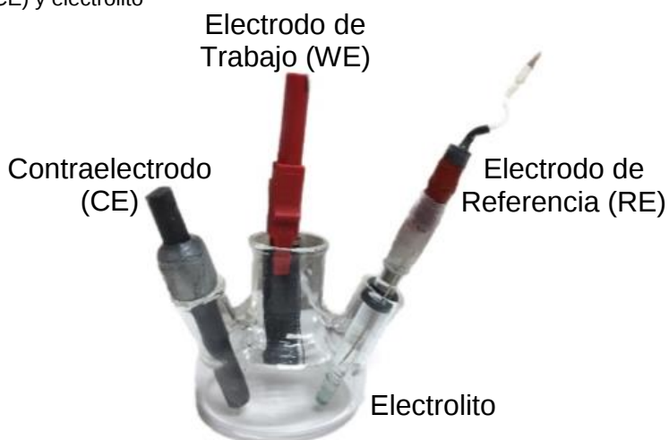
Figura 5. Celda convencional de tres electrodos. Electrodo de trabajo (WE), Electrodo de referencia (RE), Contraelectrodo (CE) y electrolito
