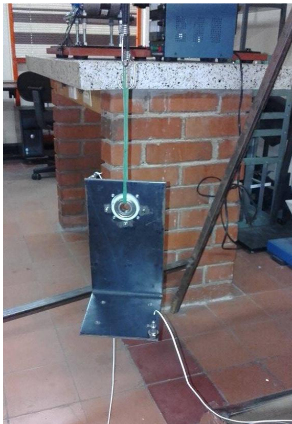
Figura 62 Soporte de perfil en “L” del eje de validación en condición de suspensión libre, para la realización del EMA
