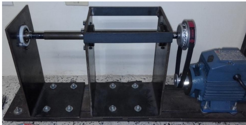
Figura 27 Banco de ensayos seleccionado para la autentificación de la técnica del OMA en ejes en condición de servicio
