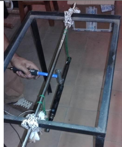
Figura 47 Realización del EMA, golpeando el eje en los puntos de medida con el Hammer
