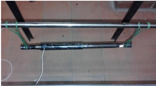
Figura 46 Eje en condición de suspensión libre y ubicación del Acelerómetro
