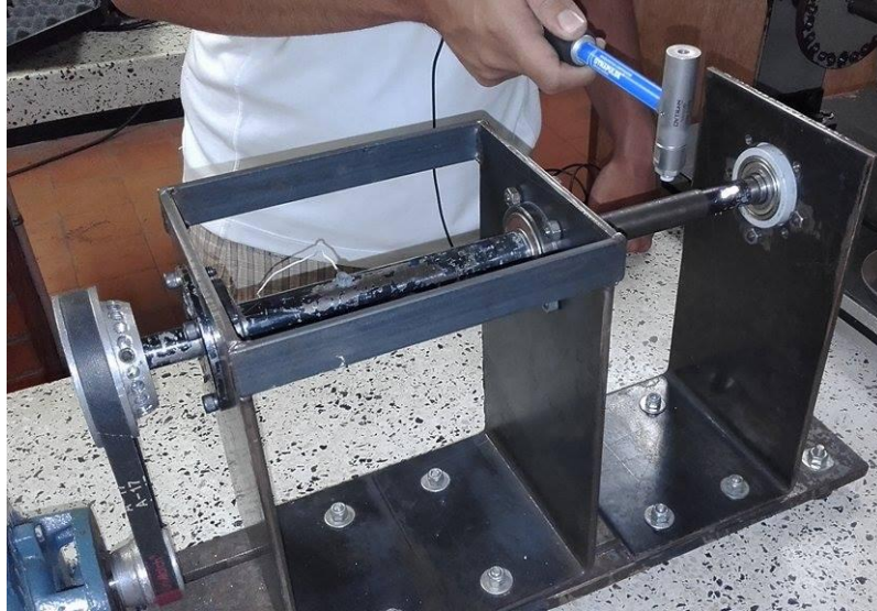
Figura 56 EMA en el “Eje de Validación” apoyado en los rodamientos
