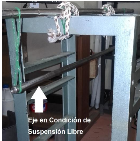
Figura 42 Montaje para la realización del EMA
