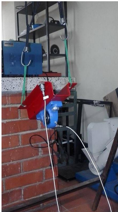
Figura 59 Soporte del eje ideal en condición de suspensión libre, para la realización del EMA
