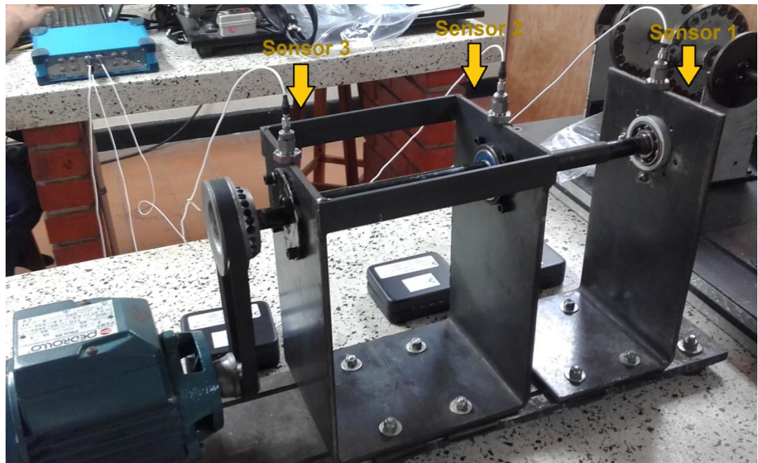
Figura 31 Adquisición de datos de aceleración para el “eje de validación”
