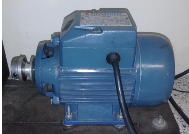
Figura 30 Motor eléctrico de operación en el “eje de validación”
