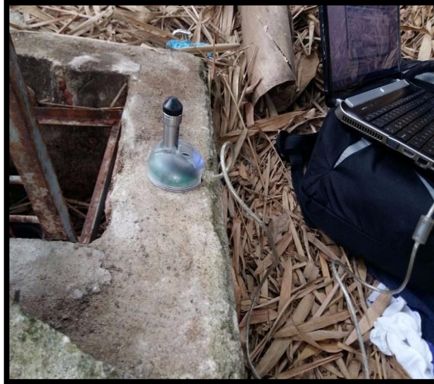
Figura 12. Descarga de la información de los equipos instalados en el pozo
