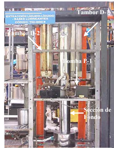
Figura 3.5 Sección de Carga
