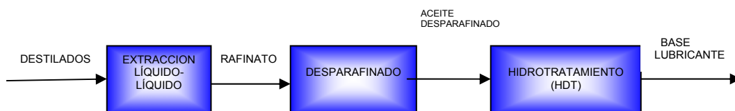
Figura 5.1 Esquema de producción de parafinas
