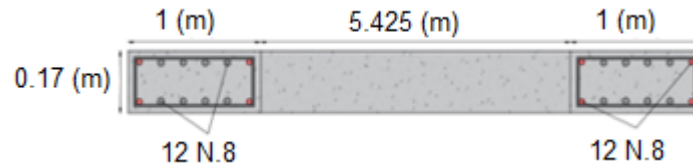
Figura 33. Detalle del refuerzo a flexión de la sección transversal del muro diseño nivel 1 edificio de 15 pisos.
