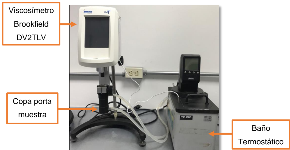
Figura 16. Equipo de medición de viscosidad, Viscosímetro Brookfield DV2TLV.
