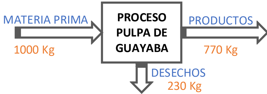
Figura 28. Diagrama de balance de masa diario de la pulpa de guayaba
