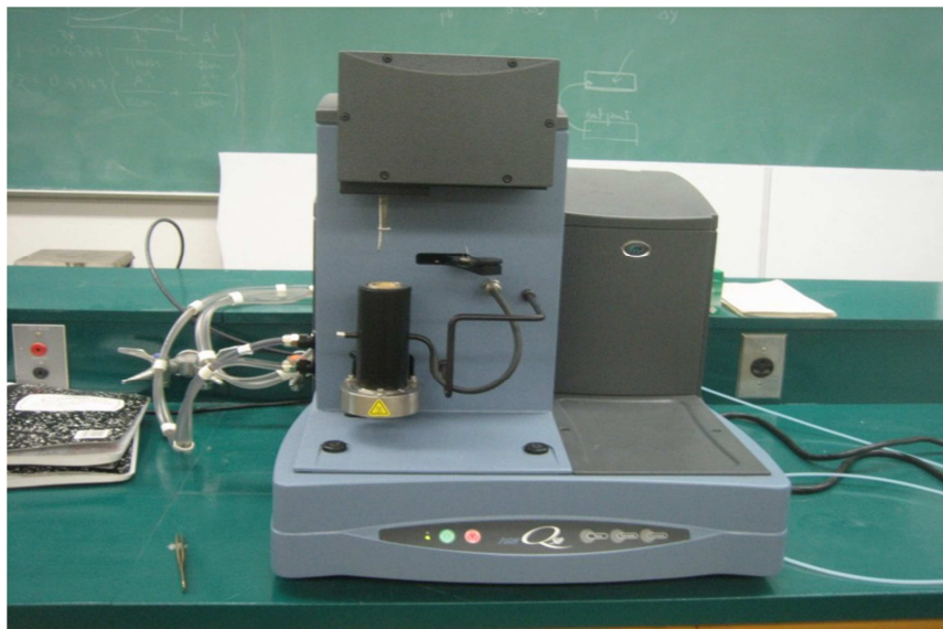
Figura 18 Equipo para la prueba TGA
