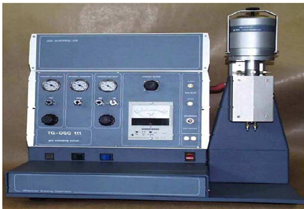
Figura 19 Equipo para una prueba DSC
