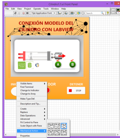
Figura 54. Cambio interruptor a pulsador
