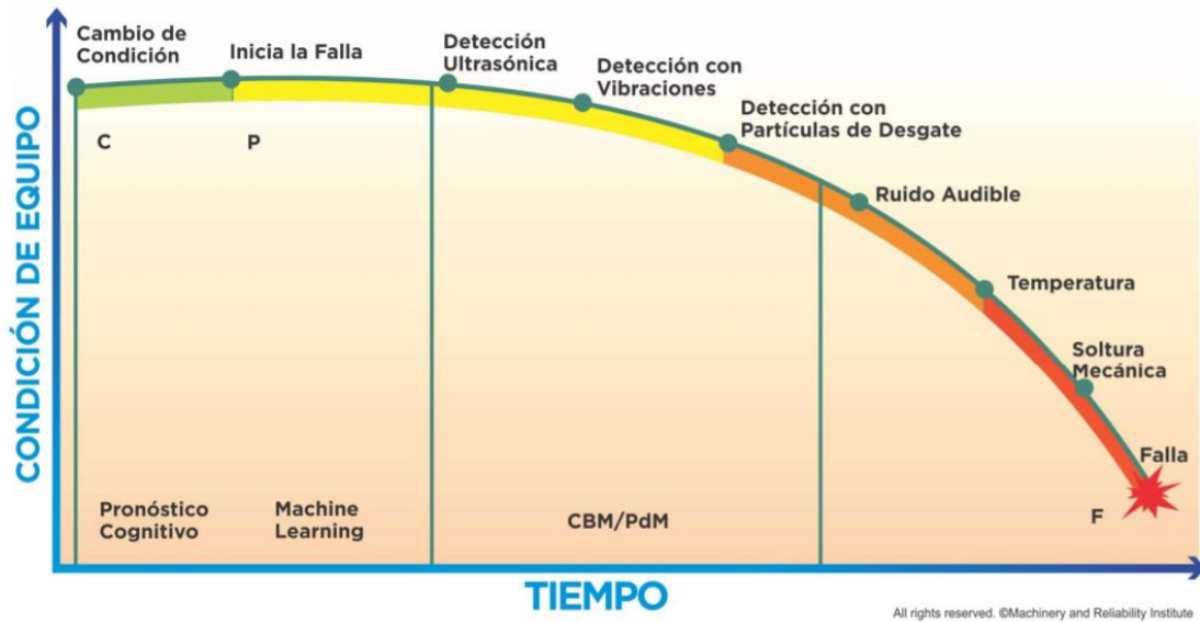
Figura 18. Curva de intervalo C-P-F de condición de equipos mediante ultrasonido. Obtenido de (Primera & Galván, n.d.)
