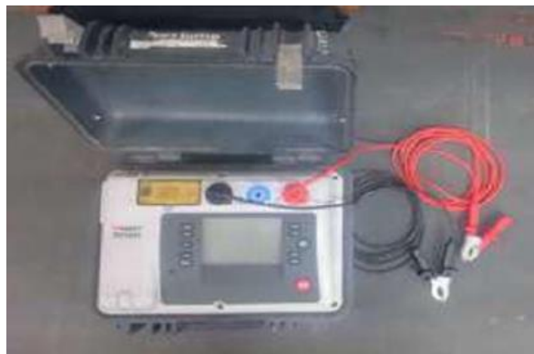
Figura 15. Instrumento de medición con la que es realizada la ronda de aislamiento. Tomado de: Ecopetrol S.A. Instructivo para medición de aislamiento a equipos de media tensión,
