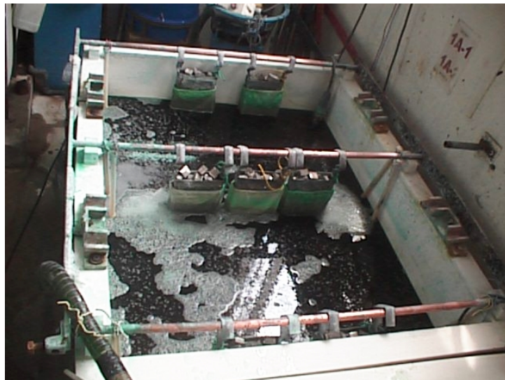
Figura G2. Baño electrolítico de níquel
