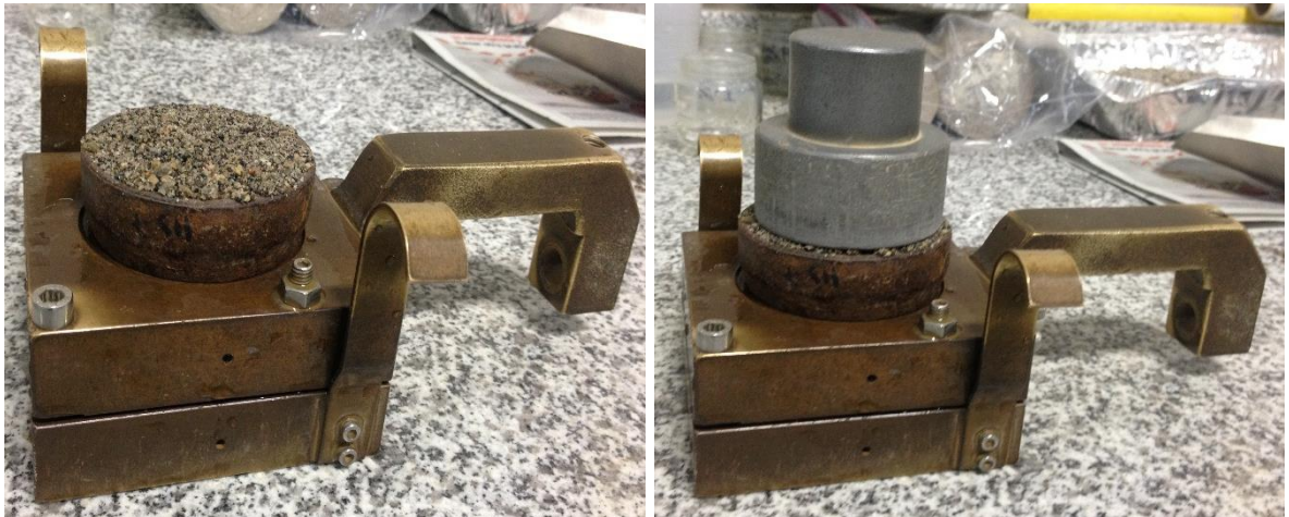
Figura 8. Procedimiento montaje de la muestra en la caja de corte directo
