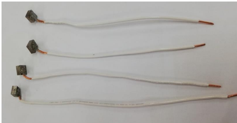
Figura 8 Probetas de acero API 5L grado B
