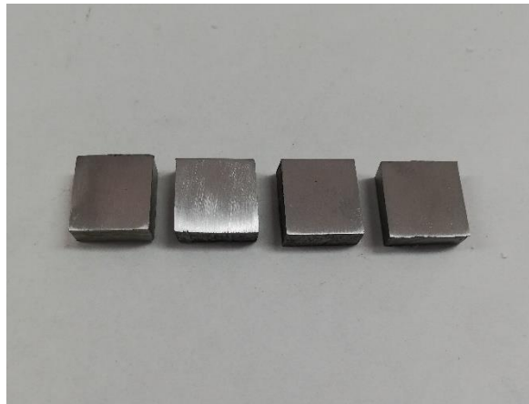
Figura 2 Probetas de acero API 5L grado B.
