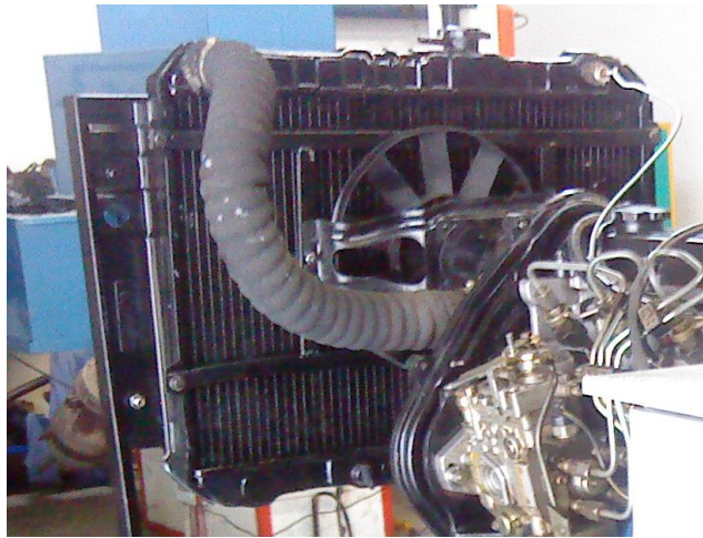
Figura 115. Reubicación del radiador del motor
