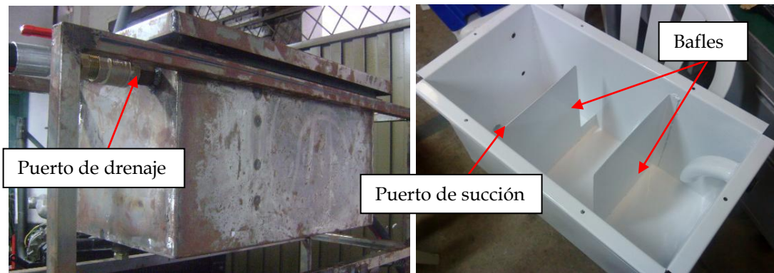
Fuente: los autores Figura109. Tanque hidráulico
