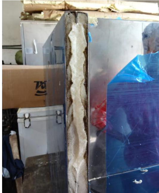
Figura 31. Panel tipo sándwich poliuretano. Fuente: Autores
