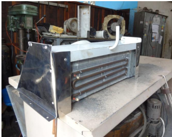
Figura 33. Evaporador Fuente: Autores
