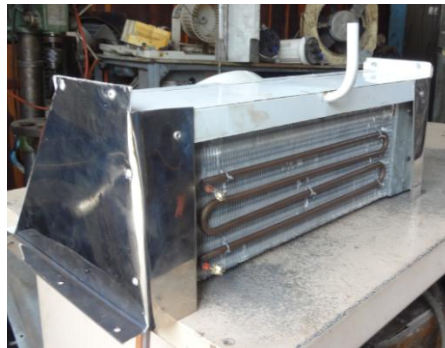
Figura 36. Instalación resistencias tubulares. Fuente: Autores
