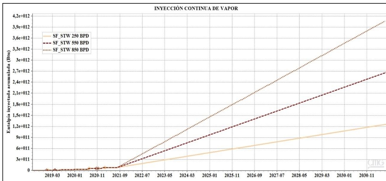
Figura C.49. Entalpía inyectada acumulada vs tiempo, sensibilidad a las tasas de inyección de 250, 550 y 800 BWPD.
