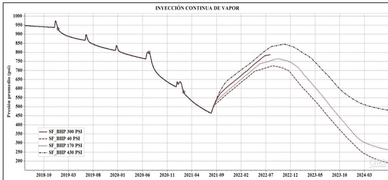
Figura C.46. Presión del yacimiento vs tiempo, sensibilidad a la BHP de 40, 170, 300 y 430 PSI.
