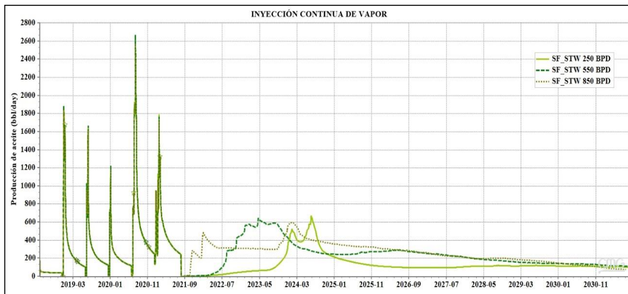
Figura C.47. Producción de aceite vs tiempo, sensibilidad a las tasas de inyección de 250, 550 y 800 BWPD.
