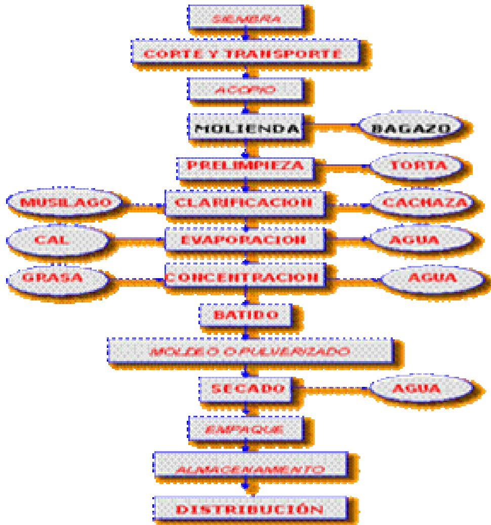
Figura 3. Diagrama de flujo de la panela
