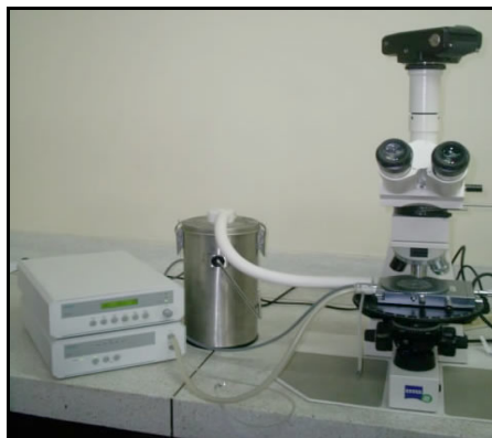
Figura 4. Equipo (Platina TH 600 Linkam adaptada al microscopio óptico Nikon Elipse 50i) utilizado para los estudios microtermométricos de Inclusiones Fluidas, del laboratorio de investigaciones geológicas, sede UIS-Guatiguará.
