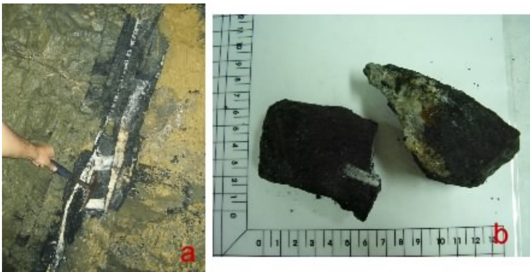
Figura 18. a) Vena paralela a la estratificación, la fotografía fue tomada en el frente del túnel. b) Fotografía de la muestra de mano LME040001, en la que se observa su aspecto masivo.
