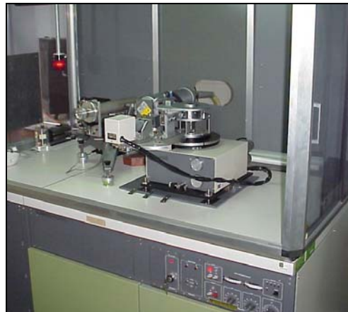
Figura 3. Aspecto del Difractómetro marca RIGAKU modelo D/MAX III B utilizado en el presente estudio. Laboratorio de DRX de la Escuela de Química de la Universidad Industrial de Santander.
