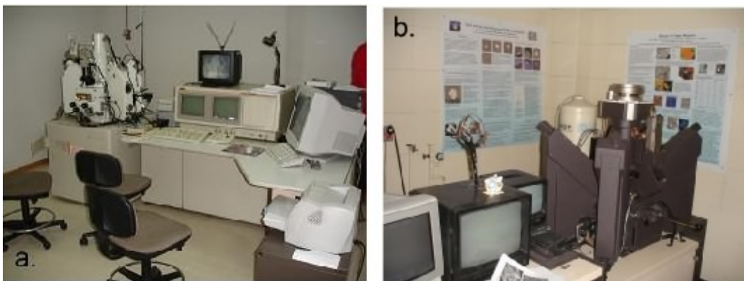
Figura 2. Aspecto de las Microsondas electrónicas, utilizadas en el presente estudio para análisis de química mineral. a) Microsonda JEOL del Centro de Microscopía Electrónica Luís Bru (Madrid España) 2b. Microsonda Cameca MBX del Electrón Microprobe Laboratory de la Universidad de Arizona (Tucson, AZ, EE.UU).
