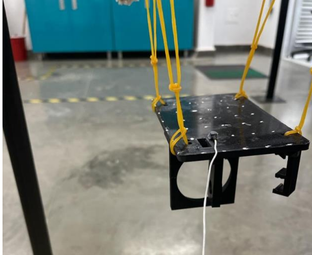
Figura 46. Estructura mecánica de la carga útil con el sensor posicionado
