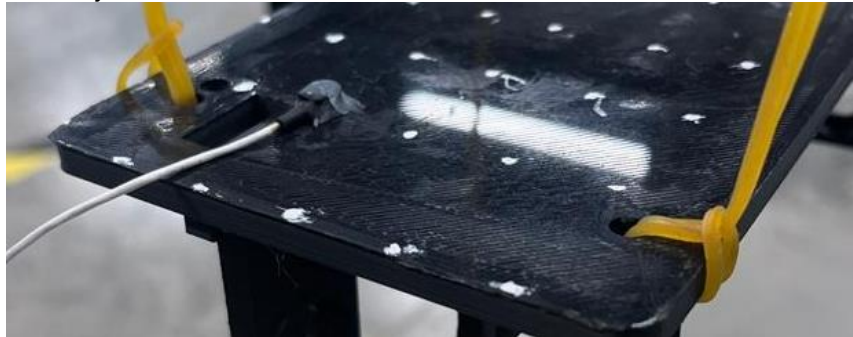
Figura 50. Montaje adhesivo del acelerómetro
