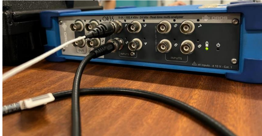
Figura 52. Conexión del sensor y del martillo en el analizador
