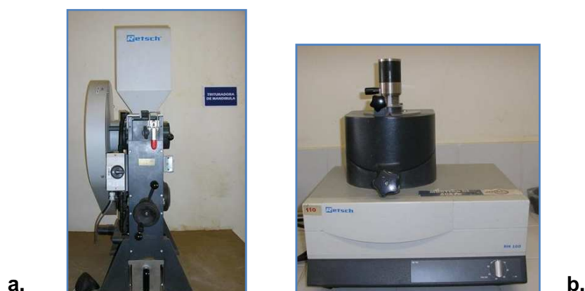
FIGURA 5. Equipos de trabajo utilizados en la pulverización de muestras. a. trituradora de mandíbula RETSCH tipo BB200 SCHWERMETALLFREI, b. mortero de Agatha RM 100 RETSCH.
