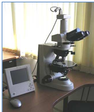
FIGURA 4. Microscopio de luz transmitida NIKON ECLIPSE E200 50/POL con cámara y pantalla incorporada: Digital Sight DS-SM y Digital Sight DS-L1 Laboratorio de microscopía óptica, Escuela de Geología, (UIS).
