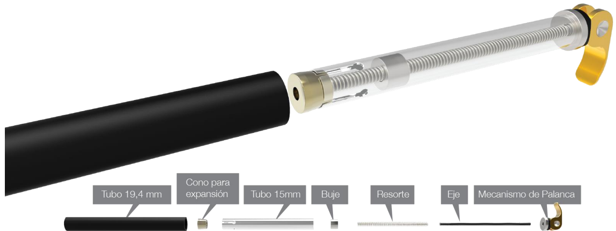
Fig 104 Detalle del sistema de expansión
