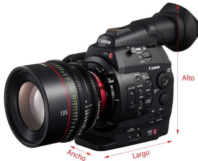
Fig.4 Dimensiones de una cámara
