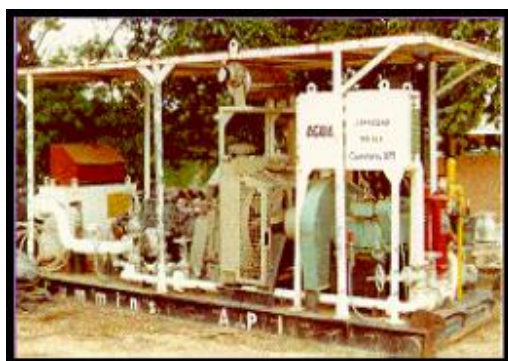
Figura 10. Equipo de llenado y presurización de tuberías
