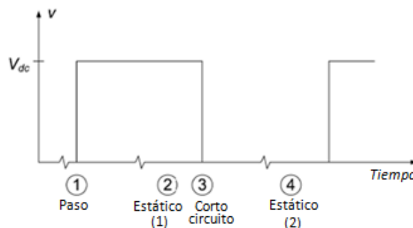
Figura 3. Perfil de Voltaje aplicado idealizado sobre los terminales (electrodos) del coalescedor.
