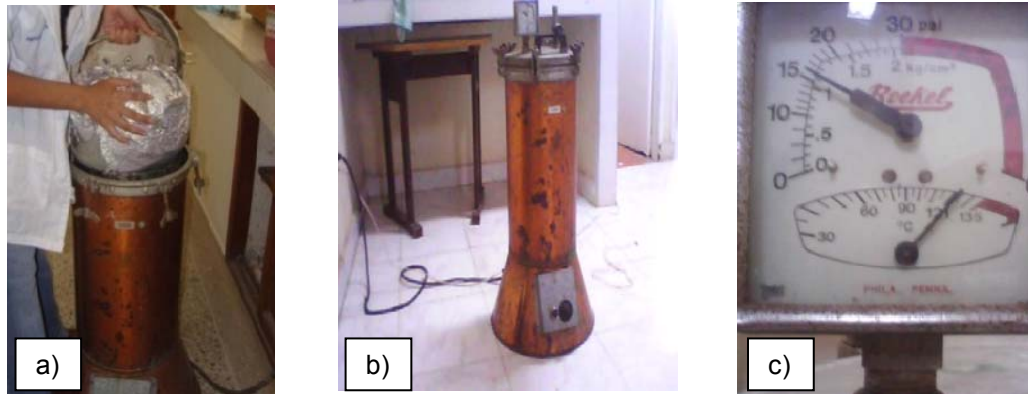
Figura 11. a) Proceso de esterilización. B) autoclave. C) manómetro a 15 libras de presión y 120°C.
