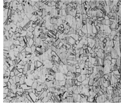
Microestructura típica del tipo 201, 200X. Ataque químico con reactivo glicerregia.
