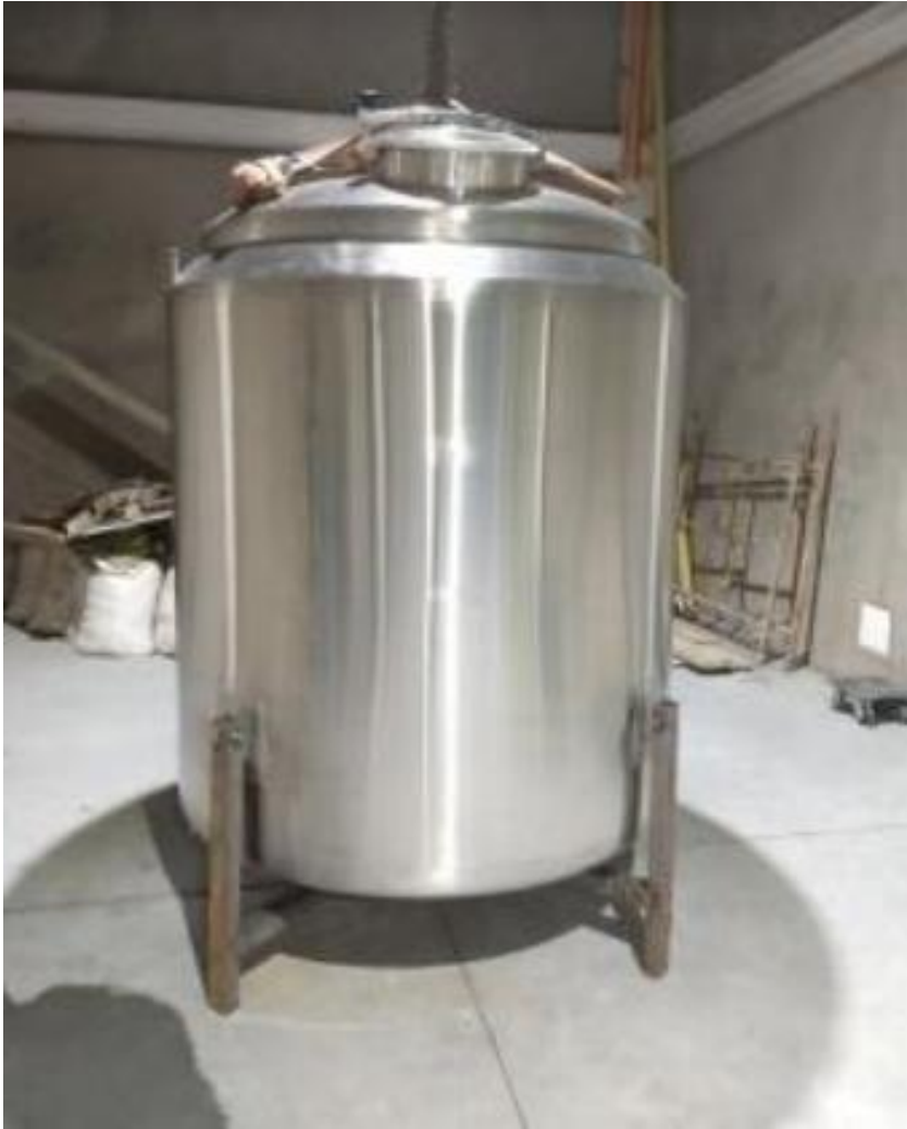
Gráfico 10 Imagen ilustrativa Tanque agitado (fuente: TERMOPLAST)
