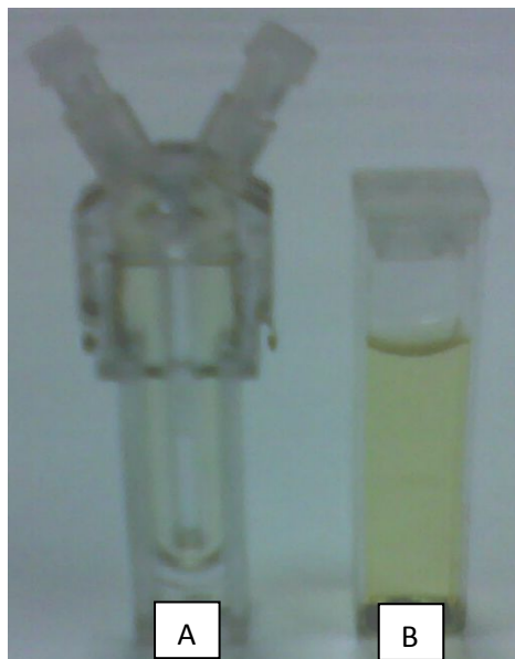
Figura 5. A) Celda capilar para medición de potencial zeta. B) Celda para medición de tamaño de partícula
