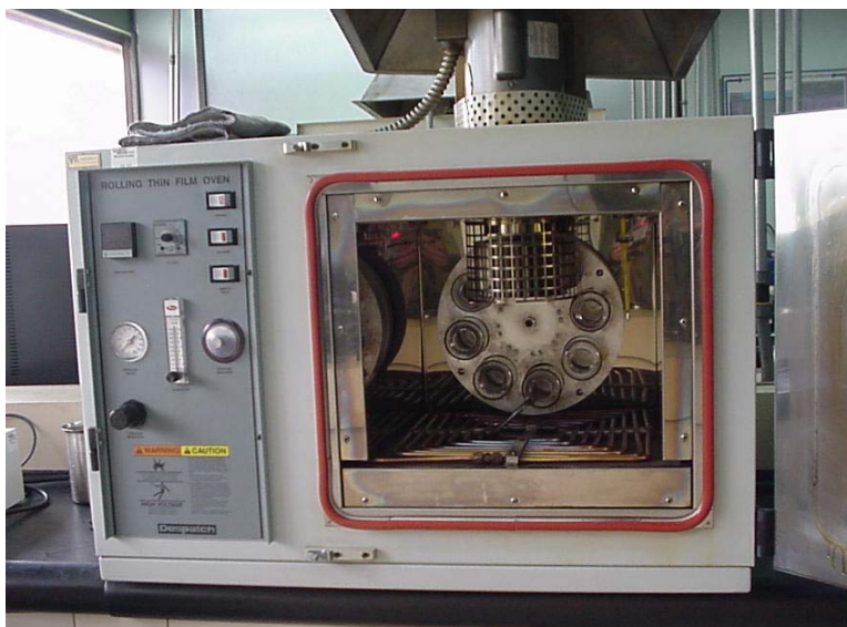
Figura 6. Horno para el Ensayo de Envejecimiento en Película Delgada Rotatoria
