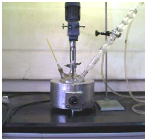
Figura 4. Montaje para la Reacción de Alquilación de Carbón
