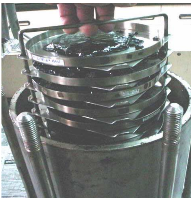
Figura 7. Montaje del reactor para el Ensayo de Envejecimiento a Presión
