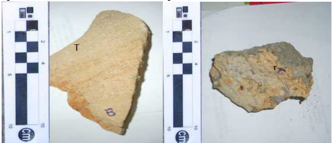
Figura 27. Arenisca en estratificación Cruzada en artesa Figura 28 Interclastos lodosos en la base de los canales.
