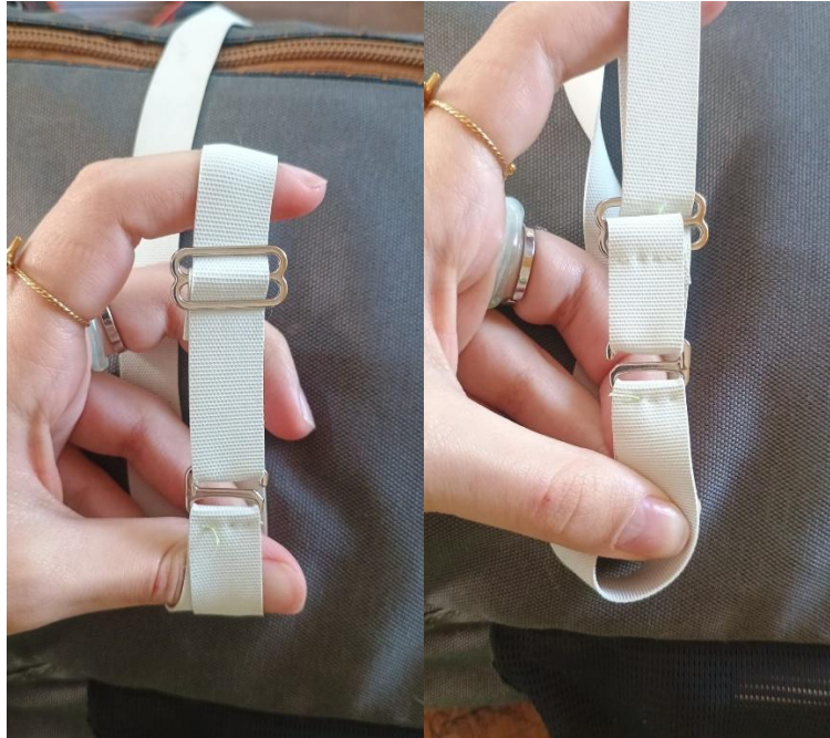
Figura 33 Prueba de bandas elásticas con herrajes y costura
