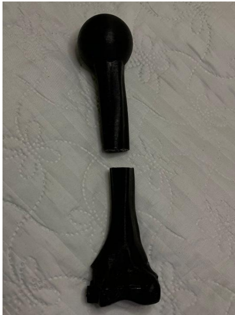
Figura 27 Prueba de resistencia en el modelo en ABS impreso en posición vertical
