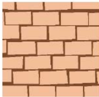
18 Figura 2.14. Modelo con juntas de espuma de goma - Mann y Müller (1982)
