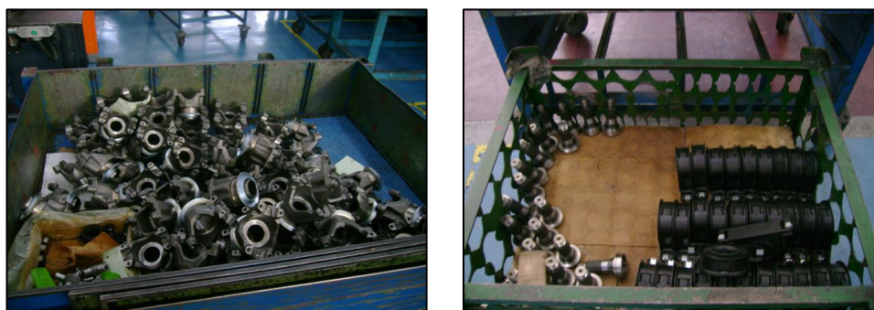
Figura 23. Medios de suministro de material para la línea de subensamble
