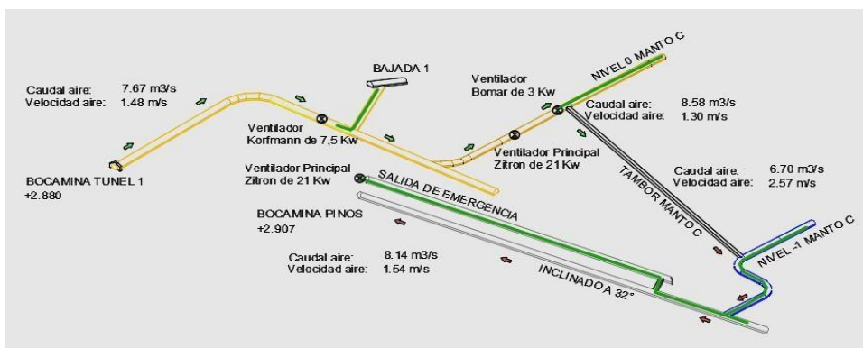
Figura 20. Isométrico de ventilación.
