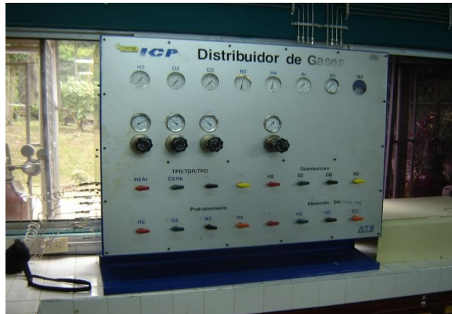
Anexo M. Panel distribuidor de gases del equipo TPD/TPR 2900.
